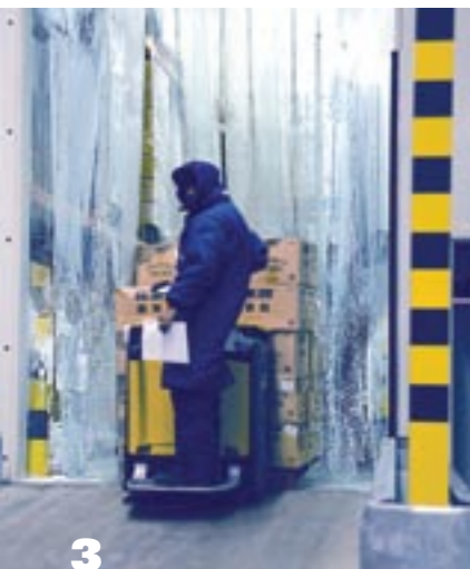
3. De batterijcapaciteit vermindert aanzienlijk door de lage temperatuur en de batterij kan alleen buiten de koelzone opgeladen worden. 4. Een speciaal aangepaste machine om te werken bij hoge temperaturen . (Foto met dank aan PSA).
