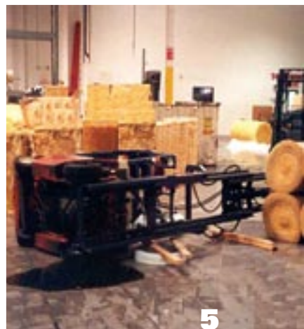
4. Het is van het grootste belang dat heftrucks van meet af aan goed beladen zijn met de vorken volledig in de unit load gestoken. 5. Heftrucks mogen nooit met hoge snelheid of een geheven last draaien of bochten nemen, aangezien het lastzwaartepunt in combinatie met de centrifugaal kracht desastreuze gevolgen kan hebben. (Foto met dank aan Allan Sloan, Alberta Forklift Safety Council, Canada).
