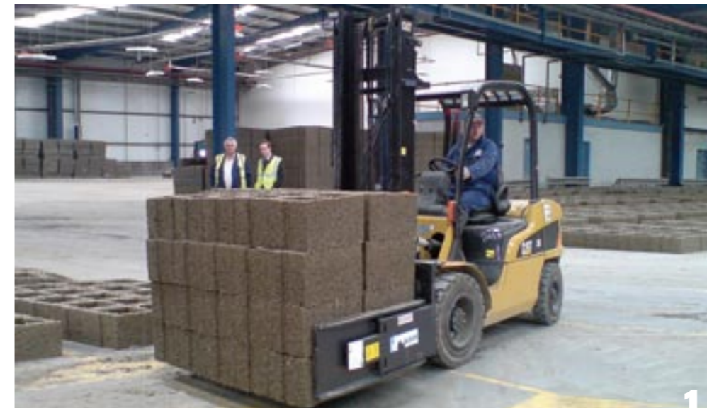
Main image: Papierrollenklem Papierrollen zijn één van de vele producten die zich niet echt lenen voor vervoer met gewone vorken (Copyright foto Getty Images). 1. Klem voor bakstenen en betonblokken De bouwrijverheid is een fervente gebruiker van voorzetapparatuur, vooral klemmen zoals deze van Kaup voor het verplaatsen van lasten die niet op pallets staan, zijn populair (Foto met dank aan B&B Attachments). 2. Klem voor schuimplastic Met voorzetstukken kunnen zelfs delicate producten vervoerd worden zoals dit schuimplastic (Foto met dank aan Bolzoni-Auramo). 3. Roterende klem Voorzetapparatuur krijgt een extra dimensie als ze lasten niet alleen kunnen grijpen maar ook kunnen draaien (Foto met dank aan Bolzoni-Auramo).
